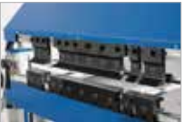
Alle drei Werkzeuge segmentiert und mit Schnellwechselsystem
