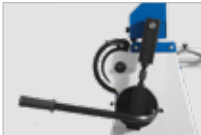
Klemmhebel mit Federunterstützung
